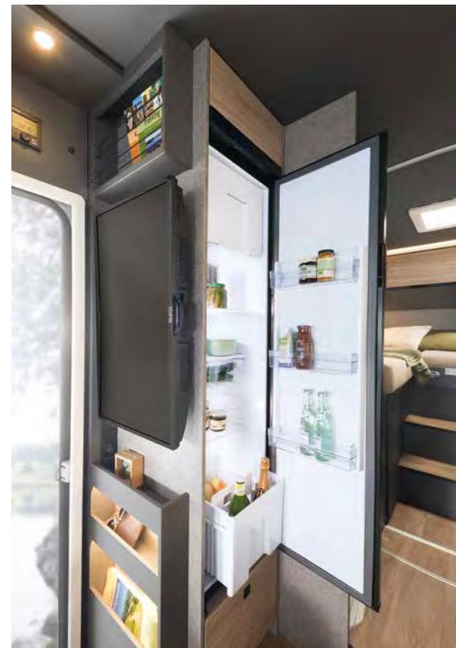
Il frigo/congelatore da 137 l è accessibile comodamente. Grazie al suo sistema AES è in grado di selezionare autonomamente il tipo di energia ottimale (12 V, 230 V o gas).
