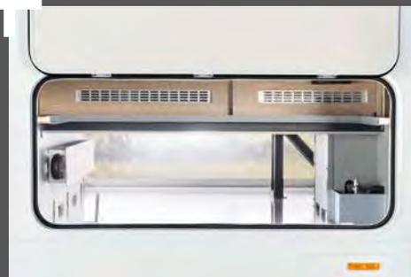
Doppio pavimento a prova d'inverno per alloggiare al riparo dal gelo tubi e serbatoi dell'acqua - con altezza utile di 360 mm e possibilità di carico passante.
