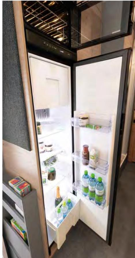
Il frigorifero in alto ha una capacità di 137 l e un reparto congelatore da 15 l. Molto comoda la funzione AES, che permette di passare automaticamente all'alimentazione energetica migliore.
