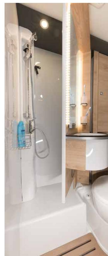
Per la trasformazione in una cabina doccia basta sbloccare semplicemente il dispositivo di arresto e ruotare la parete mobile sopra il water.
