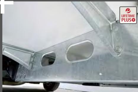
Dethleffs Lifetime-Plus: il sottopavimento senza legno è rivestito di vetroresina, pareti laterali con strisce in PUR e isolamento XPS
