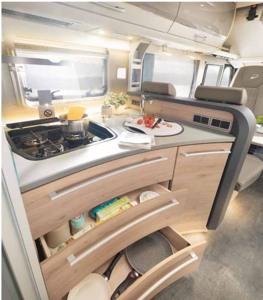
Spazio di stivaggio in abbondanza: grandi cassetti a chiusura assistita – appena iniziate a guidare il veicolo, si chiudono automaticamente. Inoltre, con la cappa aspirante verso l'esterno eviterete odori di cucina all'interno
